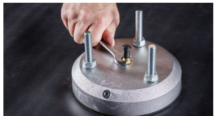
In die 2. Öffnung das Prüfventil einschrauben
