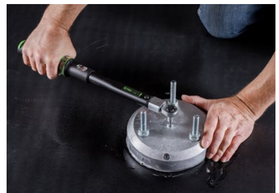
Überdruck ablassen, Prüfventil entfernen und beide Verschlusschrauben lt. Anleitung einschrauben
